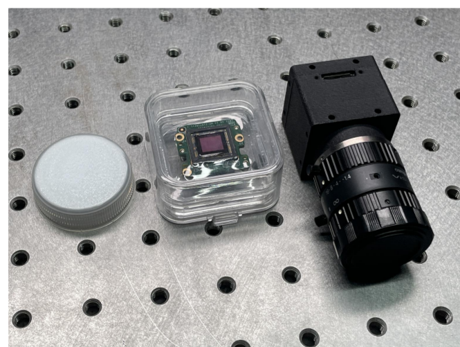
高光谱智能成像器件体积仅有矿泉水瓶盖大小，具有集成度高、重量轻、成像速度快、成像精度高等特点
